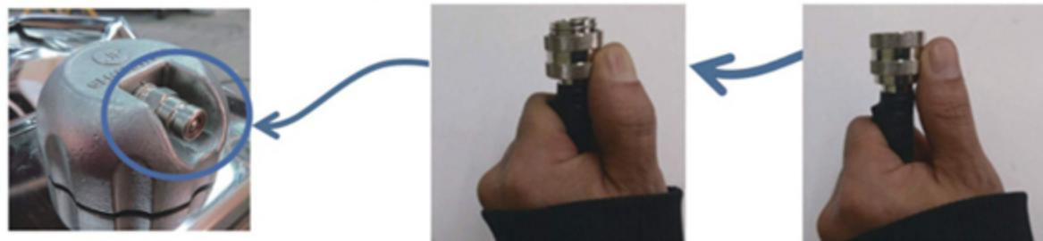
専用キャップのジョイントにポンプ付き燃料ホース先端のカプラを差し込んで接続します。
